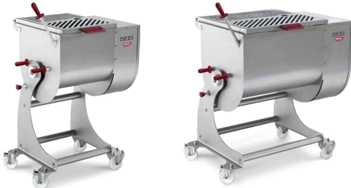
IT - Mescolatore professionale ideale per grandi negozi retail, supermercati, piccoli laboratori. Corpo, cavalletto, ruote e pale (rimovibili) in acciaio inox AISI 304. Vasca ribaltabile per lo scarico. Riduttore a bagno d'olio. Coperchio con micro di sicurezza. Comandi in acciaio inox IP 67.
