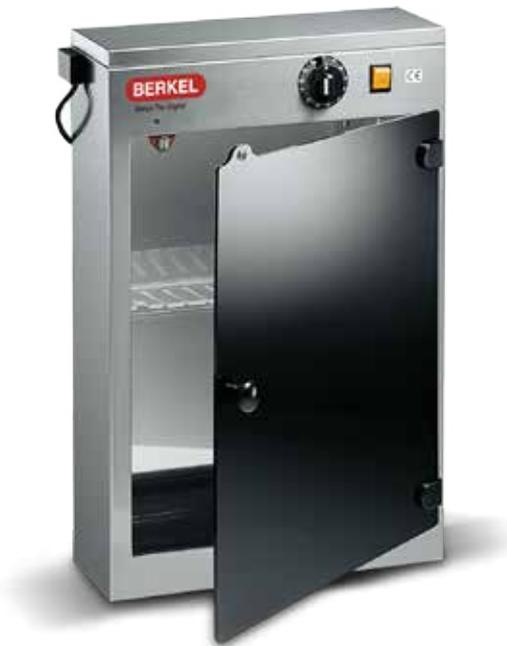
IT - Conservatore di prodotti sterili costruito in acciaio inox AISI 304. Lampada da 16 W ai vapori di mercurio. Timer programmabile da 0 ÷ 120 min. Porta in plexiglass fumé che trattiene i raggi ultravioletti. Portacoltelli estraibile per una migliore pulizia.
