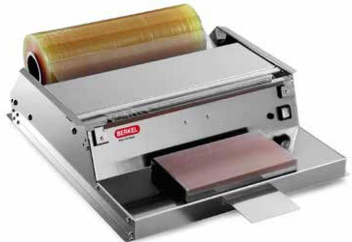
IT - Dispenser da tavolo in acciaio inox per il confezionamento manuale di alimentari con film estensibile. Sistema di presa film con guaina in plastica autoregolabile per impedirne lo slittamento. Taglio del film per mezzo di una resistenza teflonata a bassa tensione, per evitare la formazione di fumi.
